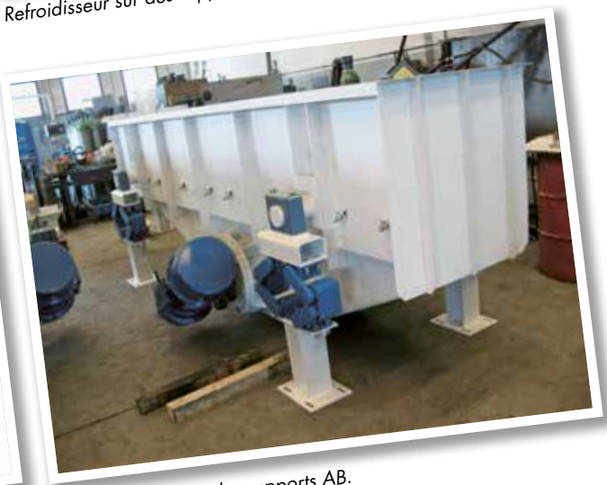
Crible à oscillations circulaires sur broyeur mobile avec des supports AB.
