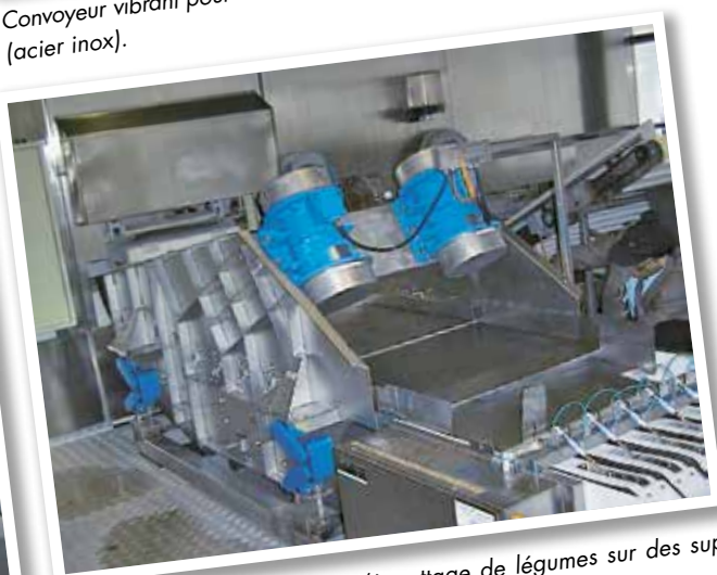
Canal vibrant pour le lavage/égouttage de légumes sur des supports AB.
