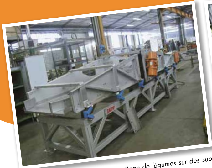
Convoyeur vibrant pour le transport de légumes sur des supports AB (acier inox).
