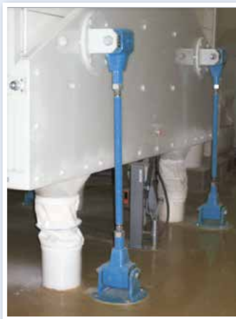
Tamiseur giratoire pour la sélection granulométrique de farines, monté sur 8 éléments AV 38
