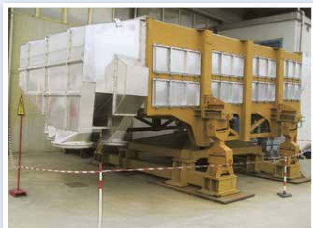
Tamiseur giratoire pour l'industrie du bois, monté sur 8 éléments AK 100-4
